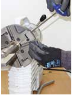
Système de serrage rapide des outils OTC® (Quick-Tool-Change)
