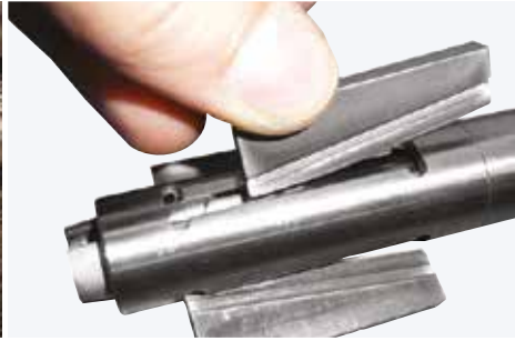
Le système de serrage "NC" et ses cales fermement ancrées dans le mandrin sont irremplaçables
